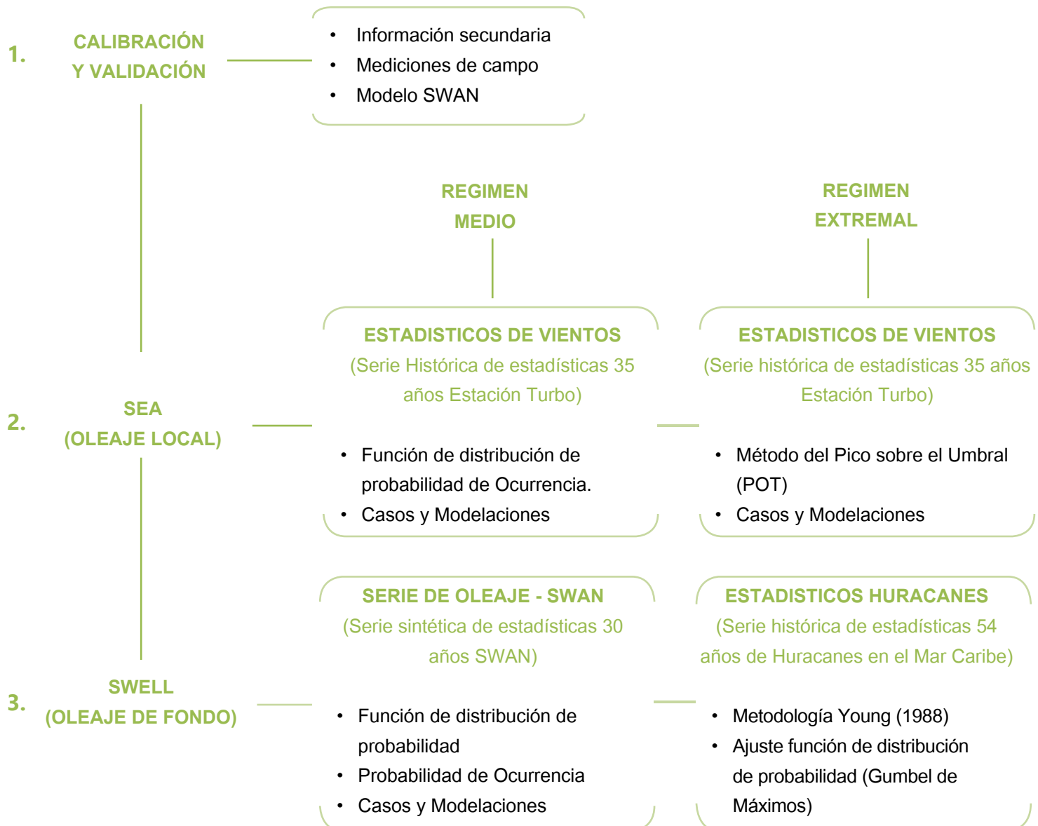
Figura 3.3. Esquema del método empleado para la determinación de los regímenes de SEA y SWELL en el golfo de Urabá.
