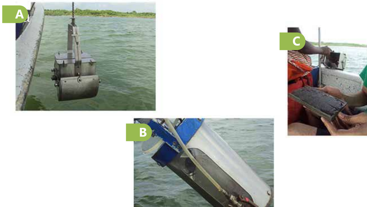
Figura 5.1. a) Caja Ekman. b) Toma del primer cm superficial. c) Botella muestreadora de agua.
