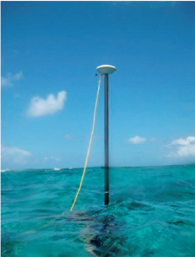
Figura 26. Instalación de mareógrafo en la isla de Quitasueño. (Foto: Dimar-CIOH).
