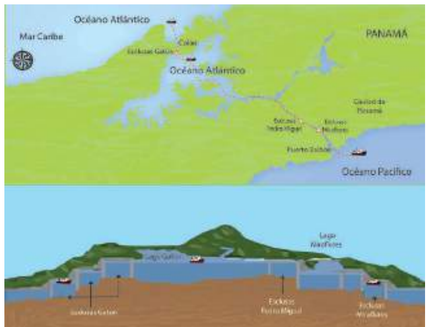
Diagrama del sistema de esclusas del Canal de Panamá
