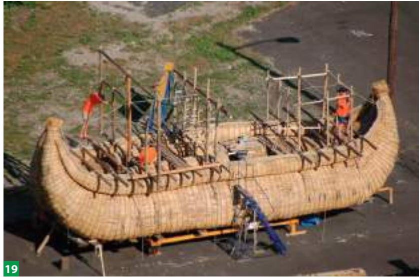
Abora III, embarcación construida con juncos a partir de diseños de embarcaciones antiguas
