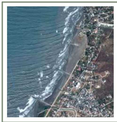
Los nuevos espolones de Puerto Colombia captan arenas de la deriva litoral.
