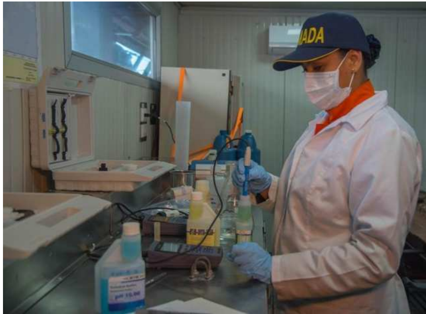
Fotografía 13. Verificación y calibración Sonda pH-metro.
