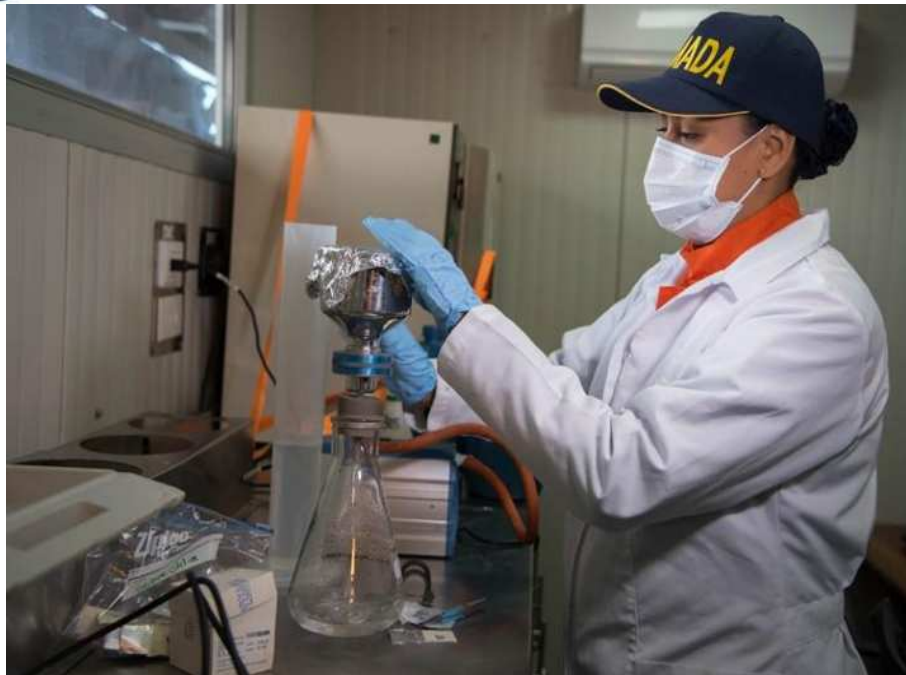
Fotografía 11. Filtración de aguas marinas, pretratamiento para obtener muestras de nutrientes y clorofila-a.
