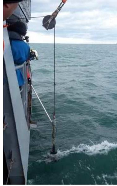
**Figura 4.** Muestreo de macrobentos mediante draga tipo shipek
