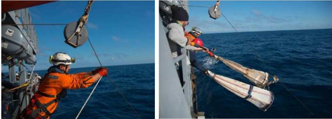
**Figura 1.** Maniobra de montaje de sistema apertura cierre para arrastres verticales y lanzamiento de redes de zooplancton e ictiplancton a profundidad 600 m (componente plántónico).
