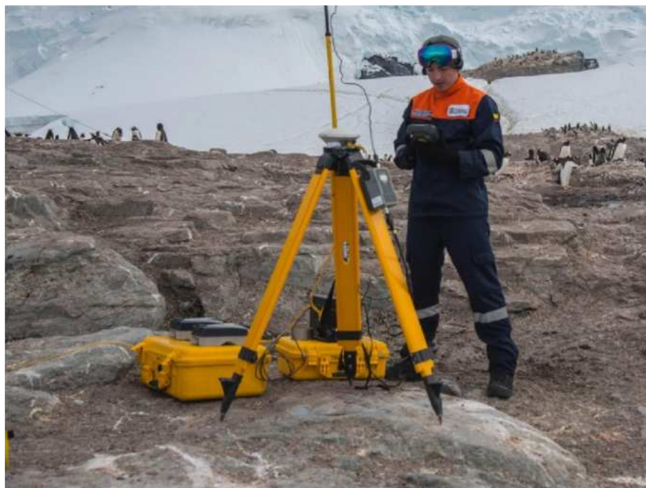
Fotografía No 2. Sistema GPS R7 Trimble, en modo de colección para un punto de control en isla Trinidad
