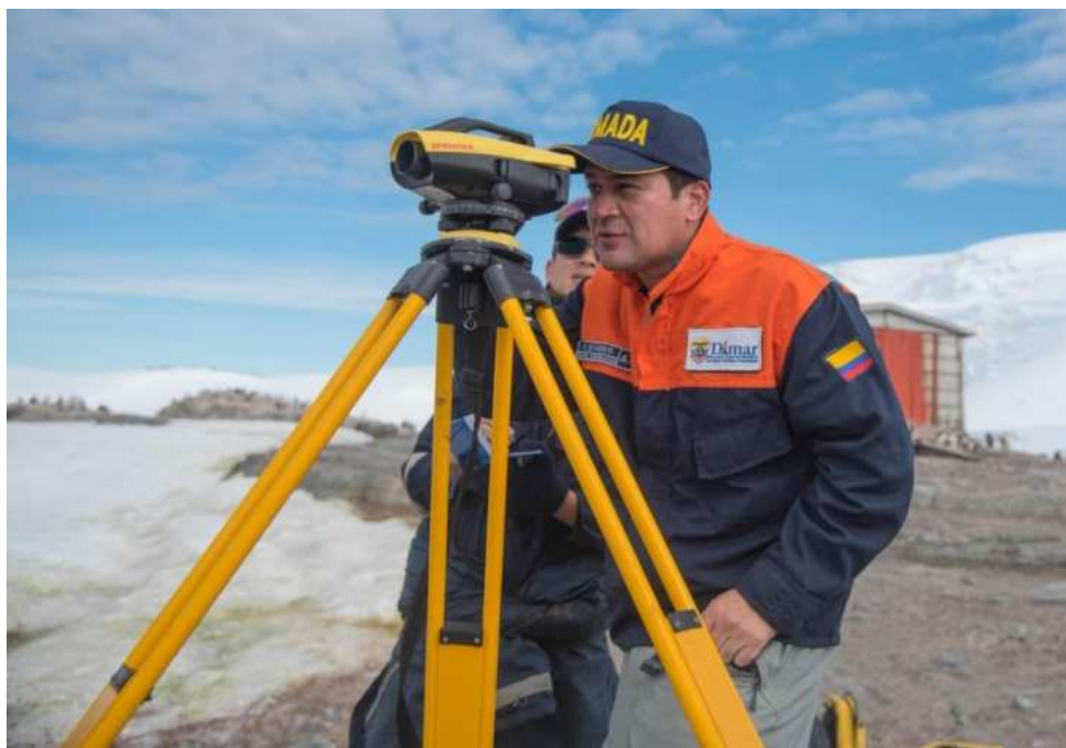
Fotografía No 3. Proceso de nivelación del punto de control en Isla Trinidad
