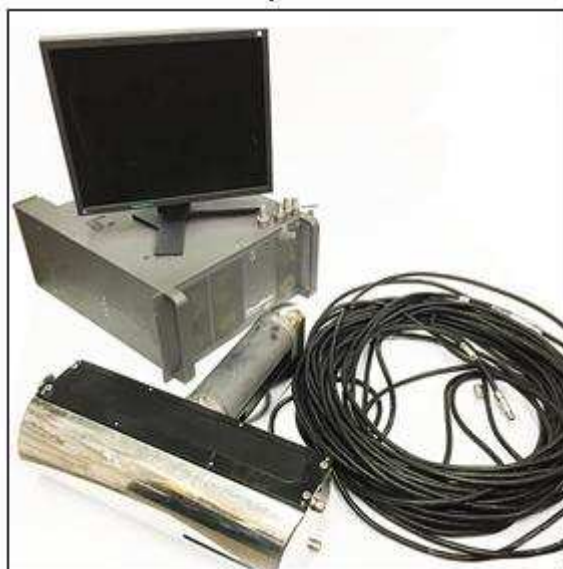
Imagen No 2 Ecosonda Seabat 7125, Teledyne Reson usada para la expedición
