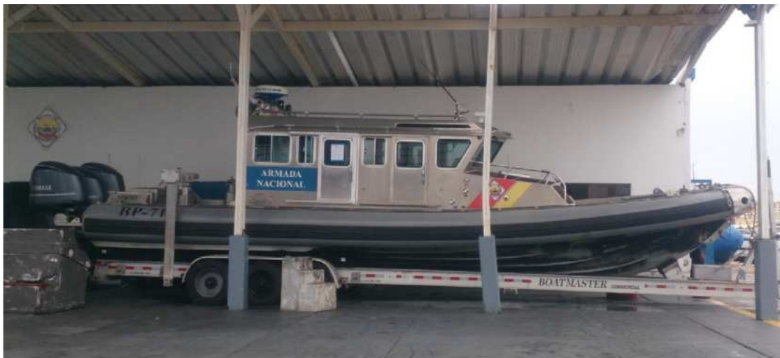
Fotografía No 1. Unidad de levantamiento batimétrico utilizada, Bote Tipo Defender BP-718
