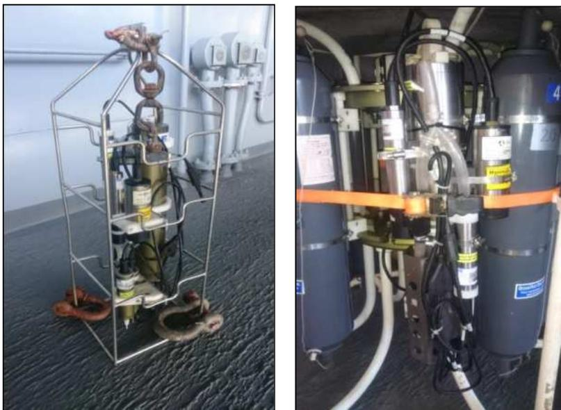
**Figura 2.** Perfiladores empleados durante las estaciones oceanográficas en el estrecho de Gerlache. De izquierda a derecha, CTDO SBE 25 y CTDO 19 Plus V2. Fuente: Autor.
