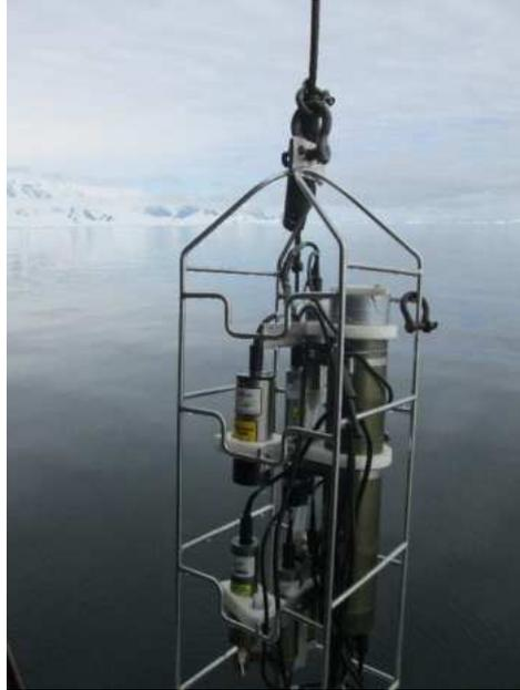
Fotografía 1. Instrumento CTDO para la medición de perfiles de temperatura, conductividad, presión y oxígeno.
