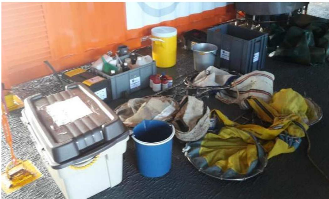
**Foto 7.** Aparejo general utilizado para la colecta de muestras de plancton (fito+zoo+ictioplancton) en la Expedición Antártica Almirante Padilla.
