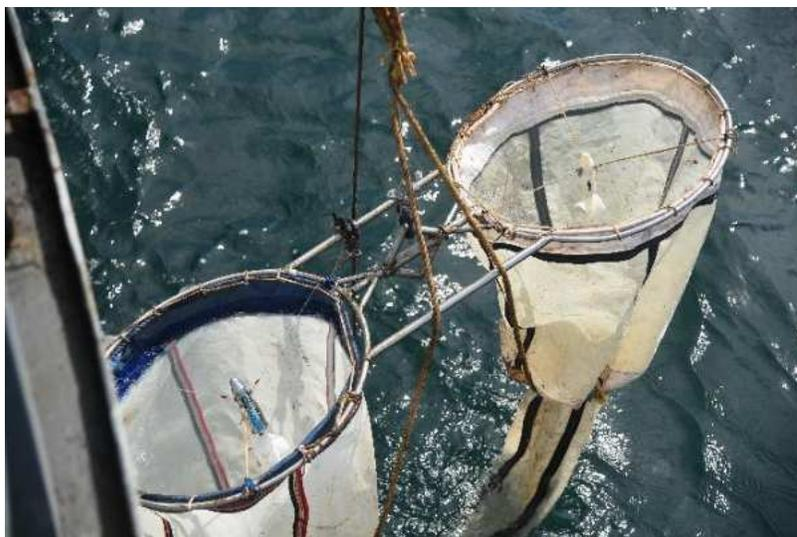
**Foto 2.** Arrastre vertical de zooplancton e ictioplancton, mediante red tipo bongo.
