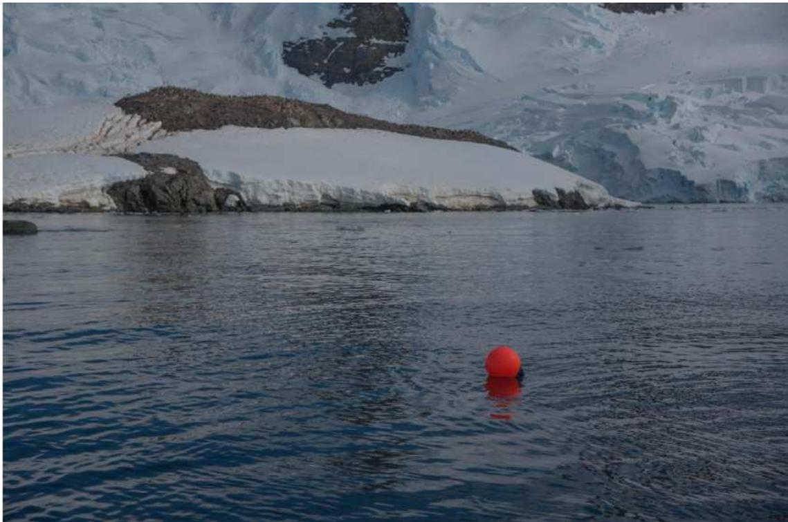
Fotografía 1. Instrumento para la medición de nivel del mar instalado en Puerto Mikkelsen.
