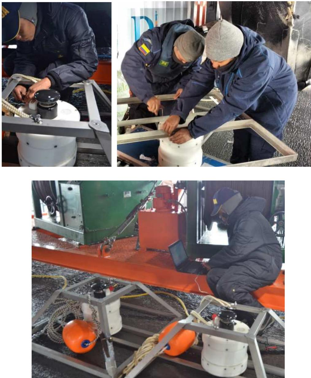
**Figura 1.** Actividades de configuración y ensamblaje de trípodes para el fondeo de 02 Registradores de Oleaje Direccional (DWR, por sus siglas en inglés) a bordo del buque ARC “20 de Julio”. Fuente: Cortesía Armada Nacional de Colombia; Escuela Naval de Cadetes Almirante Padilla (ENAP); Ángela Posada swafford.
