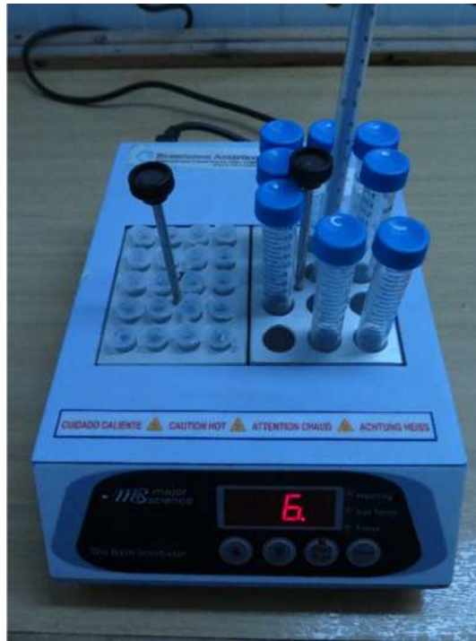
Fig 5. Termobloque usado para los experimentos de exposición térmica.
