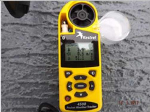
7b. Display de datos registrados con el equipo manual luego de la corroboración de su funcionamiento.
