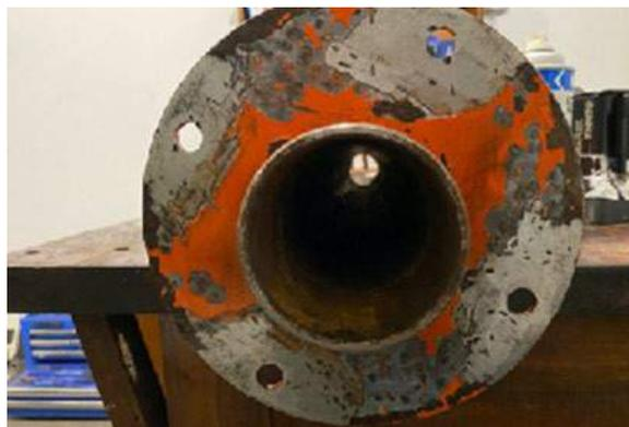
Se efectuó inspección por la técnica de partículas magnéticas a los (04) agujeros que soportan los tensores (vientos) de la base de la Turbina Eólica, durante la inspección se evidenciaron deformación en los agujeros (ovalización), entalle mecánico debido a la tensión ejercida de los por los fuertes vientos antárticos, No se evidencio indicaciones relevantes tales como (grietas).
