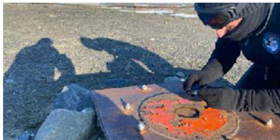
Durante la inspección por la técnica de inspección visual directa (VT) se evidenció (01) indicación tipo grieta de aproximadamente 30 milímetros de longitud con pérdida de material en el plato de sujeción principal el cual estaba soldado a una placa metálica de un calibre de 5mm en la Antártida Base Marambio.
