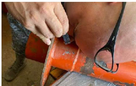
*Figura 23. inspección con tintas penetrantes, en la sección de anclaje de la mitad del poste de la Turbina Eólica año 2020. Autor CT.JIMENEZ FAC.*
