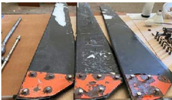
Se efectuó inspección por la técnica de ultrasonido (UT) a (03) palas de las turbina eólica, prestando principal atención en el borde de ataque, borde de salida y la unión pala - turbina, durante la inspección no se evidenciaron indicaciones relevantes como (grietas, deslaminaciones, pérdida de material por erosión), por lo cual es satisfactorio el desempeño de estas durante los dos años de funcionamiento.
