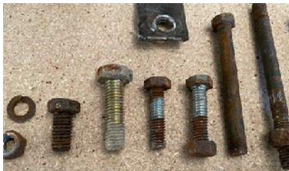
Se efectuó inspección no destructiva por la técnica de inspección visual directa (VT), utilizando lente de aumento de 10X, limpieza con SKC-S (cleaner) a toda la estructura de anclaje de la turbina eólica durante la inspección se evidencia corrosión granular en un 40% de toda la estructura, pérdida de recubrimiento anticorrosivo (pintura) en un 40% de la estructura, NO se encontraron indicaciones como (grietas, entalles o pérdida de material por corrosión).
